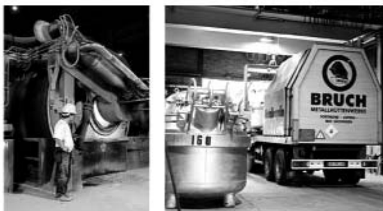
Fig. 6 Procesamiento de chatarra de aluminio en horno rotatorio y transporte de aluminio líquido
