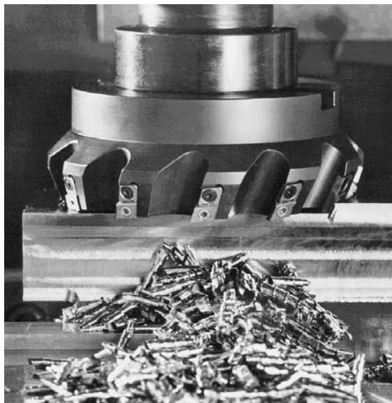
FIGURA 24.5 Cortador de fresado de careado con insertos indexables. Fuente: Cortesía de Ingersoll Cutting Tool Company.
