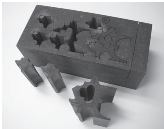
FIGURA 27.17 (a) Esquema del proceso de maquinado por chorro abrasivo. (b) Ejemplos de partes producidas mediante maquinado de chorro abrasivo, fabricadas con acero inoxidable 304 de 50 mm (2 pulgadas) de espesor. Fuente: Cortesía de OMAX Corporation.
