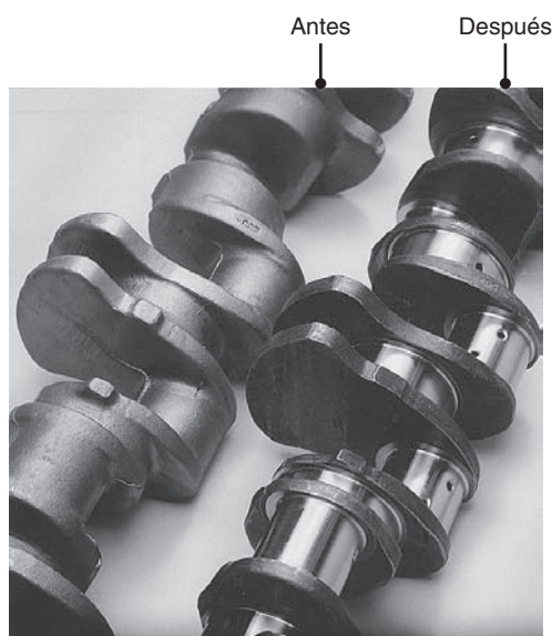
FIGURA IV.1 Un cigüeñal forjado antes y después de maquinar las superficies de apoyo. Las superficies de apoyo brillantes de la parte a la derecha no se pueden producir con esas dimensiones y acabado superficial final por ningún otro de los procesos descritos en los capítulos anteriores de este libro. Fuente: Cortesía de Wyman-Gordon Company.
