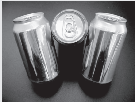
FIGURA 16.38 (a) Latas de aluminio para bebidas. Obsérvese el excelente acabado superficial.
