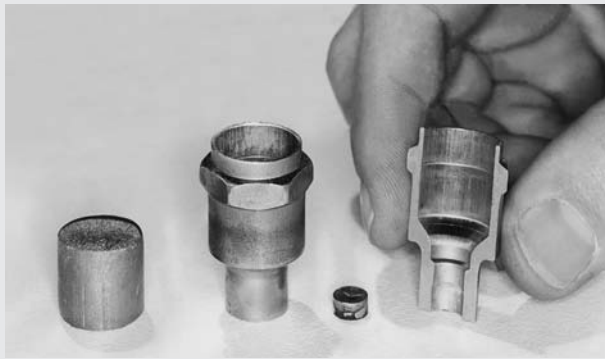
FIGURA 15.12 Pasos de producción de una bujía extruida en frío. Fuente: Cortesía de National Machinery Company.
