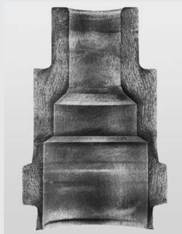
FIGURA 15.13 Sección transversal de la parte metálica de la figura 15.12 que muestra el patrón de flujo de los granos. Fuente: Cortesía de National Machinery Company.
