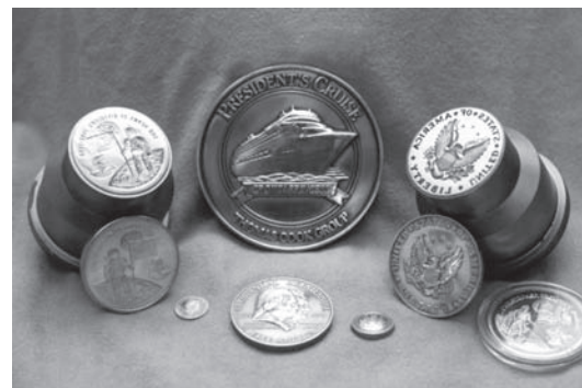
FIGURA 14.10 (a) Esquema del proceso de acuñado. Las monedas más antiguas se hacían por medio de forjado de matriz abierta y carecían de precisión y detalles de forma. (b) Ejemplo de operación moderna de acuñado que muestra la pieza de trabajo y las herramientas. Obsérvese el detalle y el acabado superficial superior que se puede obtener con este proceso. Fuente: Cortesía de C & W Steel Stamp Co., Inc.
