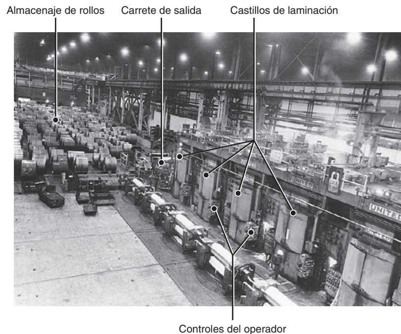
FIGURA 13.10 Vista general de un molino de laminado. Fuente: Cortesía de Ispat Inland.
