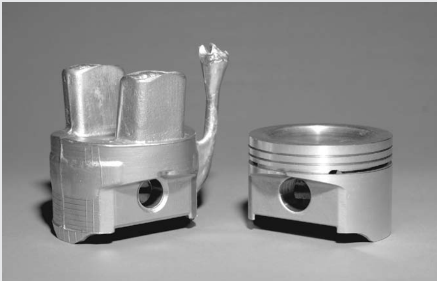
FIGURA 10.16 Pistón de aluminio para un motor de combustión interna: (a) recién fundido, y (b) después del maquinado.
