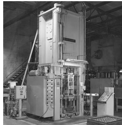
FIGURA 17.12 Prensa mecánica de 7.3 MN (825 toneladas) para compactar polvos metálicos. Fuente: Cortesía de Cincinnati Incorporated.
