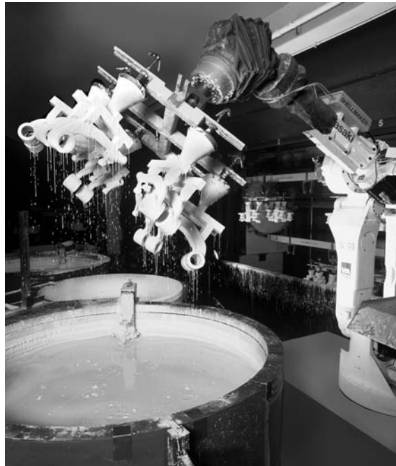
FIGURA 12.5 Un robot genera una cáscara de cerámica en modelos (árboles) de cera para fundición por revestimiento. El robot se programa para sumergir los árboles y después colocarlos en un sistema de secado automatizado. Con muchas capas, se forma una cáscara gruesa de cerámica apropiada para la fundición por revestimiento. Fuente: Cortesía de Wisconsin Precision Casting Corporation.
