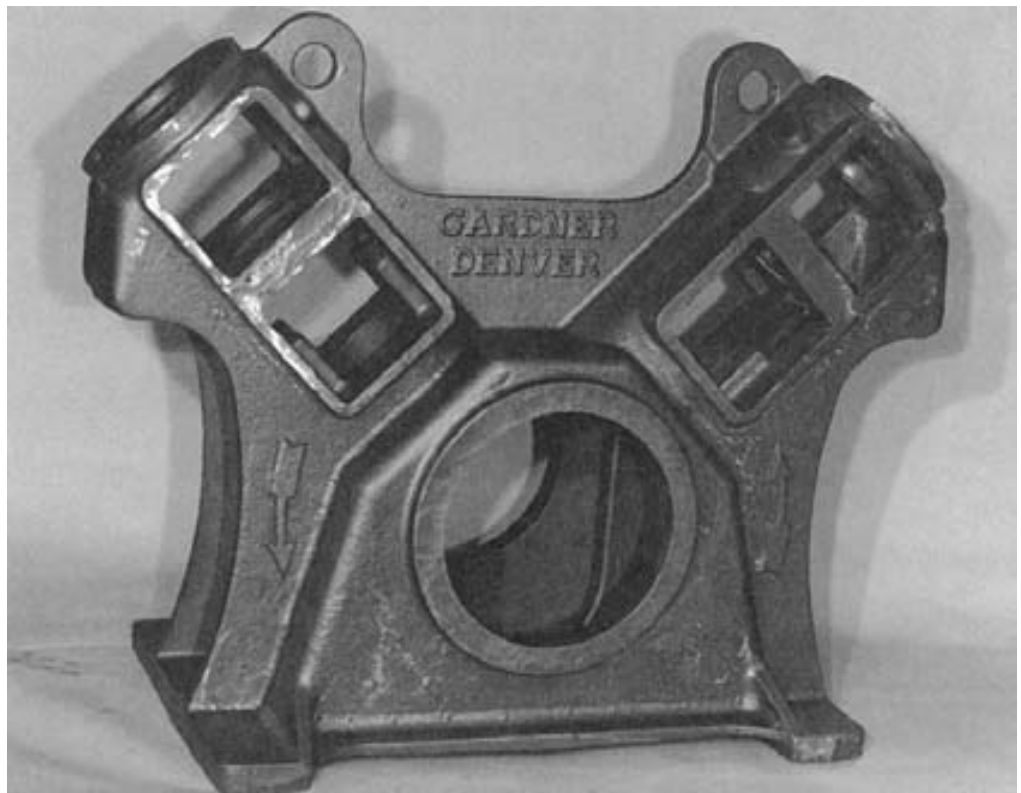
FIGURA 11.1 Pieza grande fundida con arena, pesa más de 680 kg (1 500 lb), para la estructura de un compresor de aire. (Cortesía de Elkhart Foundry, fotografía por Paragon Inc., Elkhart, Indiana).
