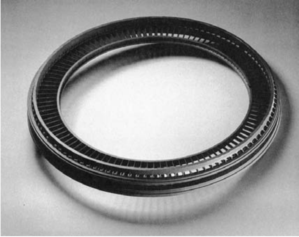
FIGURA 11.9 Estator de una pieza para un compresor, con 108 aletas aerodinámicas separadas, elaborado por medio de fundición por revestimiento (cortesía de Howmet Corp.).
