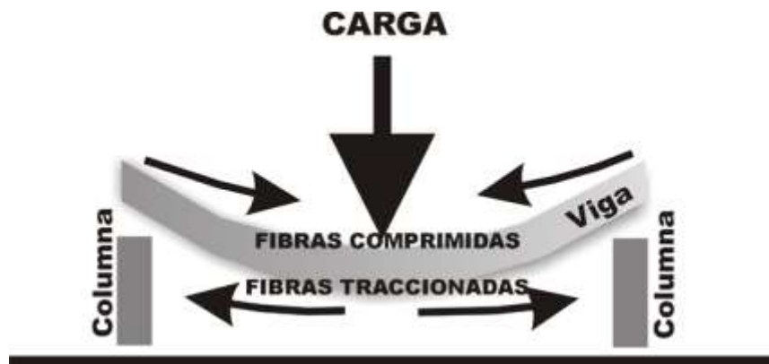
Esquema de esfuerzo: carga de FLEXIÓN en una viga soportada por columnas
