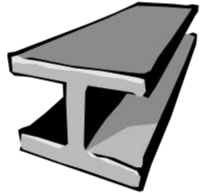
Perfil de acero doble T, utilizado para estructuras metálicas en edificios.
