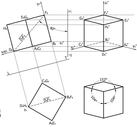
En la construcción de las dimetrías se emplea, como en las isometrías, un procedimiento directo. Primero fijamos la dirección de los tres ejes principales. Segundo, trasladamos las dimensiones de las rectas paralelas a los ejes principales y, como dos de éstos forman igual ángulo con el plano de proyección, trazamos paralelas a la misma escala y también al tercero, pero a escala proporcionalmente mayor o menor.
