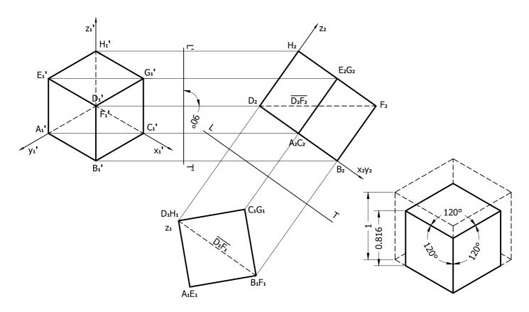
En vez de construirse una proyección isométrica a partir de un conjunto de proyecciones, se hace un procedimiento directo. Se fija la dirección de los tres ejes principales que definen entre ellos ángulos de 120° trazando un eje vertical y los dos restantes formando un ángulo de 30° con una horizontal.
