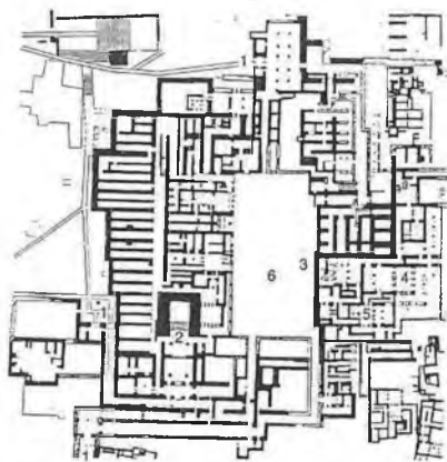
[4] Plano del palacio de Cnosos más reciente, en el estado anterior a su destrucción a finales del siglo xv a. C. Disposición laberíntica en torno al patio rectangular; curso quebrado del muro exterior: al ser de varias plantas se acentúa el desconcierto en la unión de los recintos; comunicación por escaleras con claraboyas, habitaciones configuradas como salas de pilares: 1, entrada; 2, escalera a la planta superior; 3, escalera al «subterráneo» de la parte oriental; 4, salón; 5, alcoba de las reinas, y 6, patio.
