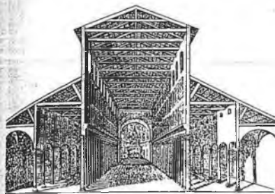
[133] Vista interior reconstruida de la basílica de San Pedro en Roma, 324. Articulación basilical de las paredes ópticamente estilizada: columnatas o arcadas—pared con mosaicos e incrustaciones—, ventanería alta, techumbre abierta de vigas; recinto orientado hacia el ábside (altar, trono episcopal).
