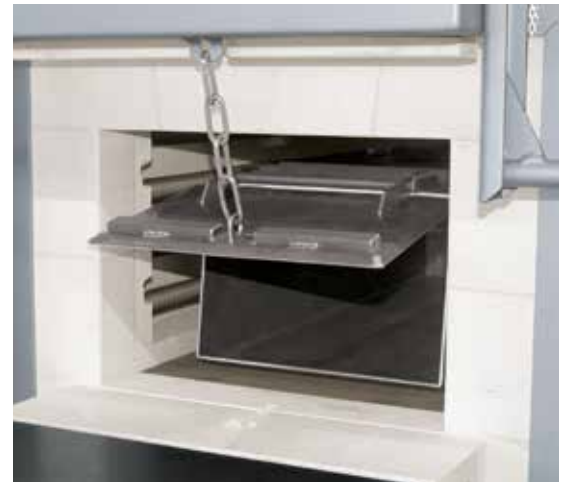
Caja de recocido con tapa que se abre junto con la puerta del horno
