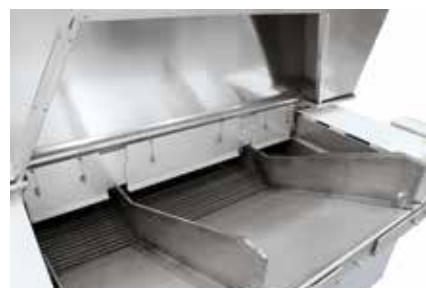
Cinta de transporte realizada como correa de eslabones, disponible también como transportador de rodillos
