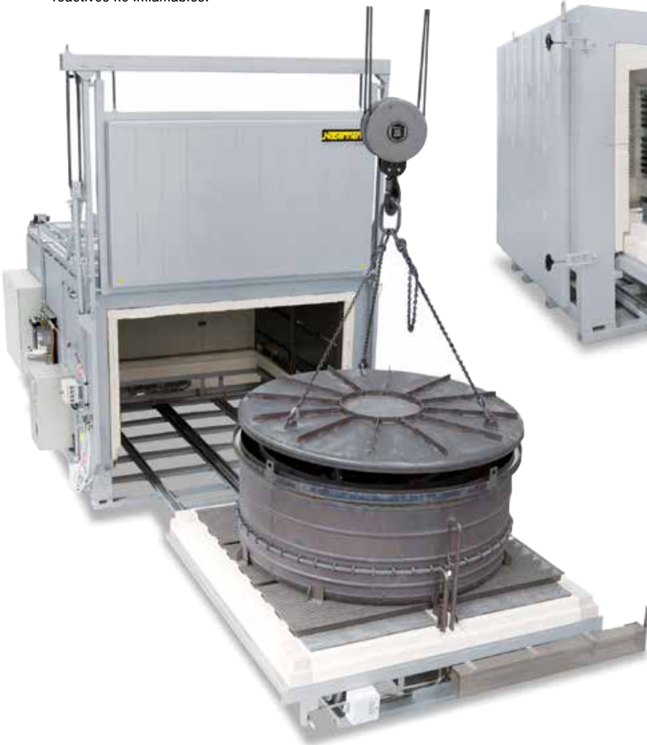
Horno de vagoneta con aire circulante W 5290/85 AS con caja de recocido para tratamiento térmico de bobinas bajo gas protector
