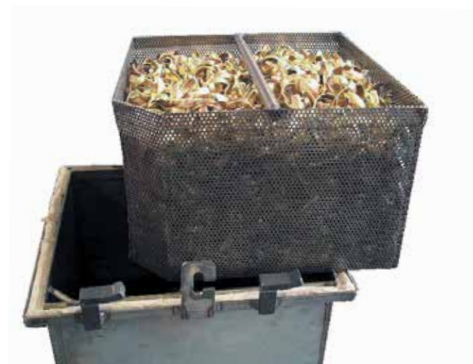
Recocido brillante de producto a granel con caja de recocido con posibilidad de evacuación
