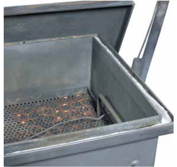
Tratamiento térmico bajo atmósfera de gas protector en una caja con inyección de gas que incluye termopar de carga
