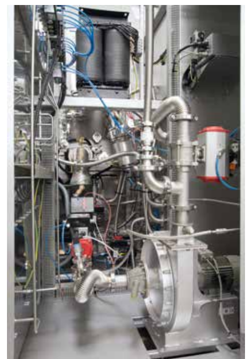
Refrigeración rápida por gas del horno de retorta de pared fría VHT 8/16-MO
