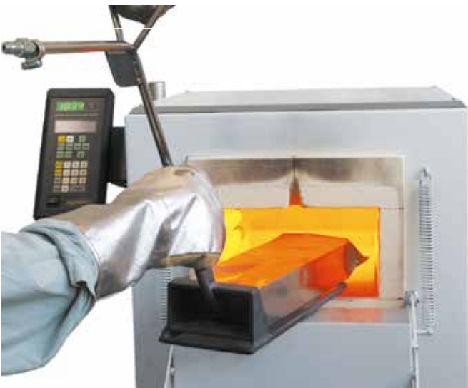
Proceso de temple con bolsa de recocido
