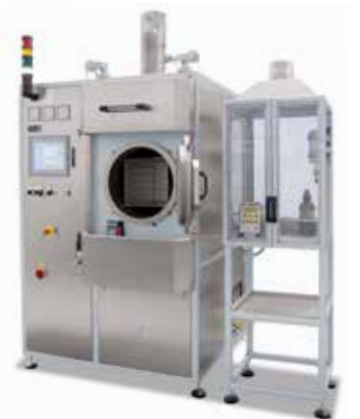
Horno de retorta NRA 40/02 con armario para bomba de ácido
