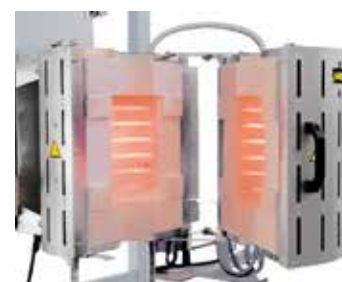
RS 100/250/11S en acabado desplegable para montaje en un dispositivo de prueba.
